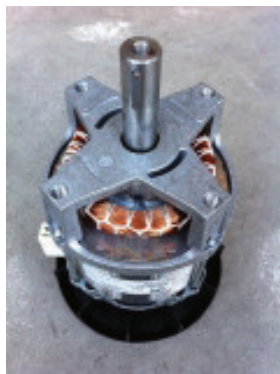
ATB Elektromotor Technische Daten: 1,40 kW / 2810/min 230 V 50 HZ
